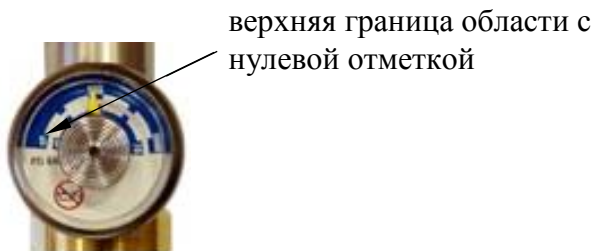
Рисунок 19 – Манометр на редукторе баллона
