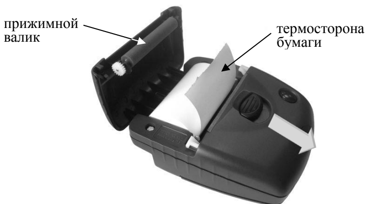
Рисунок 16 – Установка термобумаги в принтер
